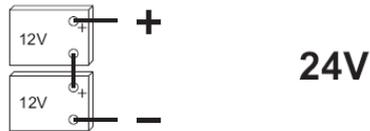
Beispiel: 2 Batterien 12 V / 100 Ah in Reihe geschaltet ergeben eine Anschlussspannung von 24 V mit 100 Ah.
