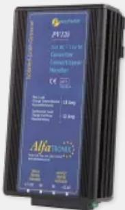
Der galvanisch getrennte DC-DC-Wandler der PV-Reihe wandelt problemlos eine 24-V-Bordnetzspannung zu einer stabilen 12-V-Bordnetzspannung. Die Geräte der PV-Reihe zeichnen sich durch kompakte Abmessungen, niedriges Gewicht und einen hohen Wirkungsgrad aus. Der DC-DC-Wandler wird mit einem praktischen Montageclip befestigt, wodurch der Einbau einfach und die Einbauzeit sehr gering ist. Eine grüne LED zeigt den Betriebsstatus des Gleichspannungswandlers an.
