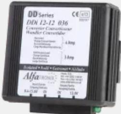
Galvanisch getrennter DC-DC Wandler in kompakter Schaltnetztechnik mit Schutzart IP65. Der DDi 12-12 036 12-12V/3A ist rüttel- und vibrationsfest und stellt bei einer Eingangsspannung von 12 VDC eine stabile Ausgangsspannung von 13,6 VDC mit bis zu 3 A (Dauer), 3,75 A (2 min) bereit. Er zeichnet sich durch einen hohen Wirkungsgrad von >93% aus und kann in einem Temperaturbereich von -25 ... +80°C betrieben werden. Der Anschluss erfolgt per 6,3 mm Flachsteckverbindung.
