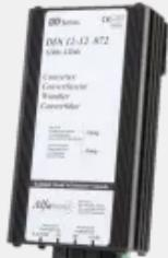
Galvanisch getrennter DC-DC Wandler in kompakter Schaltnetztechnik mit Schutzart IP53. Der DDi 12-12 072 12-12V/6A ist rüttel- und vibrationsfest und stellt bei einer Eingangsspannung von 12 VDC eine stabile Ausgangsspannung von 13,6 VDC mit bis zu 6 A (Dauer), 7,5 A (2 min) bereit. Er zeichnet sich durch einen hohen Wirkungsgrad von >85% aus und kann in einem Temperaturbereich von -25 ... +80°C betrieben werden. Der Anschluss erfolgt per 6,3 mm Flachsteckverbindung.
