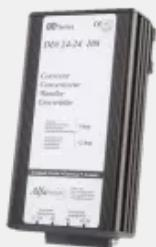
Galvanisch getrennter DC-DC Wandler in kompakter Schaltnetztechnik mit Schutzart IP53. Der DDi 24-24 108 24-24V/4,5A ist rüttel- und vibrationsfest und stellt bei einer Eingangsspannung von 24 VDC eine stabile Ausgangsspannung von 27,2 VDC mit bis zu 4,5 A (Dauer), 5,625 A (2 min) bereit. Er zeichnet sich durch einen hohen Wirkungsgrad von >85% aus und kann in einem Temperaturbereich von -25 ... +80°C betrieben werden.
