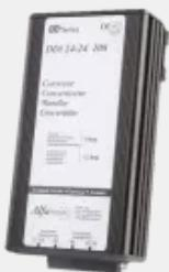
Galvanisch getrennter DC-DC Wandler in kompakter Schaltnetztechnik mit Schutzart IP53. Der DDI 24-24 108 24-24V/4,5A ist rüttel- und vibrationsfest und stellt bei einer Eingangsspannung von 24 VDC eine stabile Ausgangsspannung von 27,2 VDC mit bis zu 4,5 A (Dauer), 5,625 A (2 min) bereit. Er zeichnet sich durch einen hohen Wirkungsgrad von >85% aus und kann in einem Temperaturbereich von -25 ... +80°C betrieben werden. Der Anschluss erfolgt per 6,3 mm Flachsteckverbindung.
