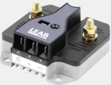
Der Batteriewächter schützt ihre Geräte vor Tiefentladung über einen 2-Stufen Unterspannungs- und Überspannungsschutz mit Abschaltung, wenn die Batteriespannung 16 V bei einem 12-V-System oder 32 V bei einem 24-V-System übersteigt.
