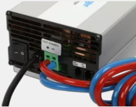
Das Ladegerät ABC 2430: Optimale Ladung von 24-V-Batterien mit einem Ladestrom von 30 A. Zusätzlich können eine Fernanzeige oder ein Temperatursensor (CTS) angeschlossen werden. Die Batterieladung erfolgt vollautomatisch und mikroprozessorüberwacht mit wählbarer Ladekennlinie – so ist eine optimale und schonende Ladung garantiert.
