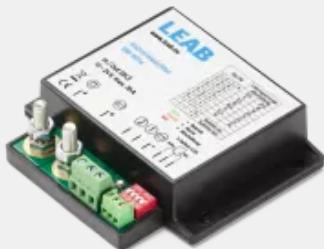
Unterspannungsschutz mit Abschaltung über elektronisches Relais
