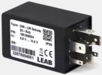
Das CAN-LIN Gateway stellt die wichtigsten Daten der LPS II auf dem CI-Bus bereit und erlaubt somit die Integration der LPS II in ein CI-Bus-Bordmanagementsystem. Neben den Informationen zu Strom, Spannung und Leistung für Solar, Bordnetz und Außeneinspeisung wird der Ladezustand der LPS II ebenso auf dem CI-Bus bereitgestellt, wie man den 230 V/12 V Ausgang als auch die Notstartfunktion der LPS II ein- und ausschalten kann.
