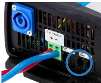
Anschluss ist mit ‚Temp. Sense‘ gekennzeichnet.
