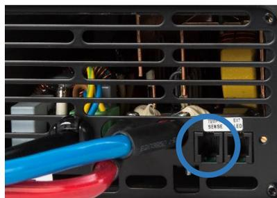
Anschluss ist mit ‚Temp. Sense‘ gekennzeichnet.
