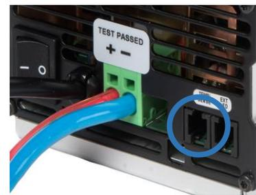
Anschluss ist mit ‚Temp. Sense‘ gekennzeichnet. Bei Typen mit nur einem Westernanschluss ist dieser für die Sensorleitung.
